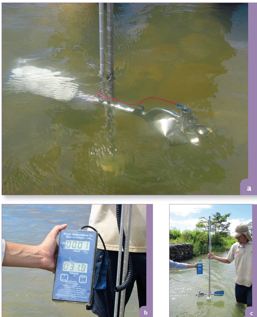
Figura 3.2 Molinete. a) Medidor de corriente, b) contador y c) equipo completo.
