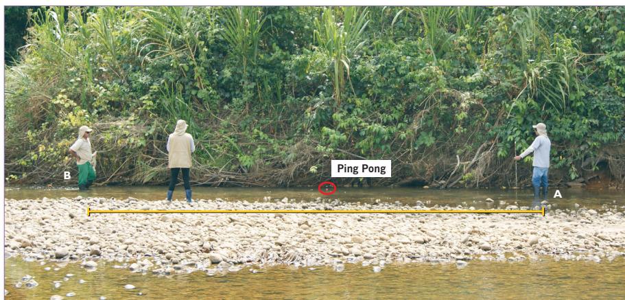
Figura 3.3 Medición de velocidad con flotador. Sección del río Orotoy 300 m aguas abajo de la confluencia con el caño Carnicerías.
